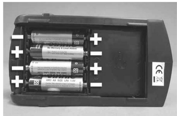
Legen Sie 4 "AA" Batterien in das Batteriefach des Senders ein.
